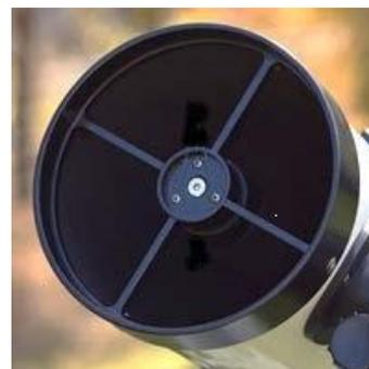
Figure 3. Araignée placée à l'ouverture d'un télescope
