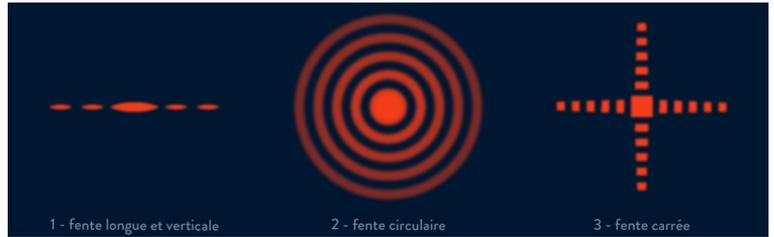
Pour trouver le diamètre d'une ouverture, il suffit de mesurer la tâche centrale  $L$  avec une règle, la distance fente-écran  $D$  et lire sur le LASER la longueur d'onde  $\lambda$ . En utilisant l'approximation des petits angles qui dit que  $\tan \theta = \theta$ , on a  $\tan \theta = \theta = \frac{L}{2D} = \frac{\lambda}{a}$ . Ce qui implique que  $a = \frac{2\lambda \cdot D}{L}$ .
